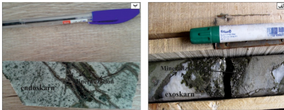
شکل ۲ کانه‌زایی رگچه‌ای گسترده اکسیدی، سولفیدی و کربناتی در (الف) پهنه آگرو اسکارن؛ (ب) پهنه اندو اسکارن.
