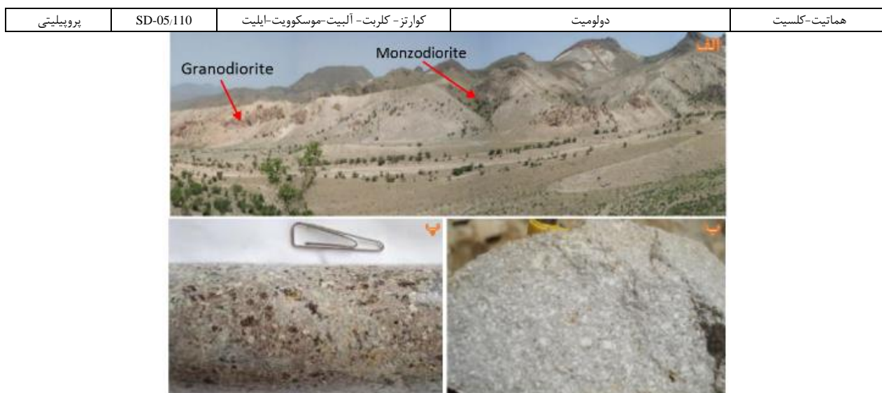
شکل ۳ الف) نمای کلی از منطقه مورد بررسی شامل توده گرانودیوریتی (Gd) با دگرسانی آرژیلی به همراه واحدهای مونزودیوریتی (Md)، ب) تصویر نمونه سطحی از توده گرانودیوریتی با بافت پورفیری و دگرسانی آرژیلی و پ) تصویر مغزه حفاری از توده نفوذی گرانودیوریتی.
