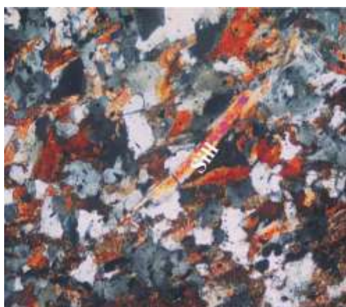
شکل ۶ بلورهای منشوری طویل سیلیمانیت (sill) تشکیل شده در زمینه سنگ. عرض عکس برابر با ۳٫۵ میلیمتر است.
