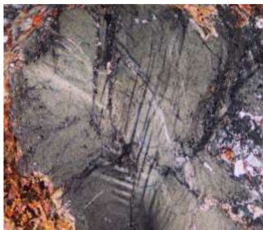
شکل ۱۱ ساختار منطقه‌ای برآمده از دگرشکلی در بلور آندالوزیت (And). عرض عکس برابر با ۴/۲ میلی‌متر است.
