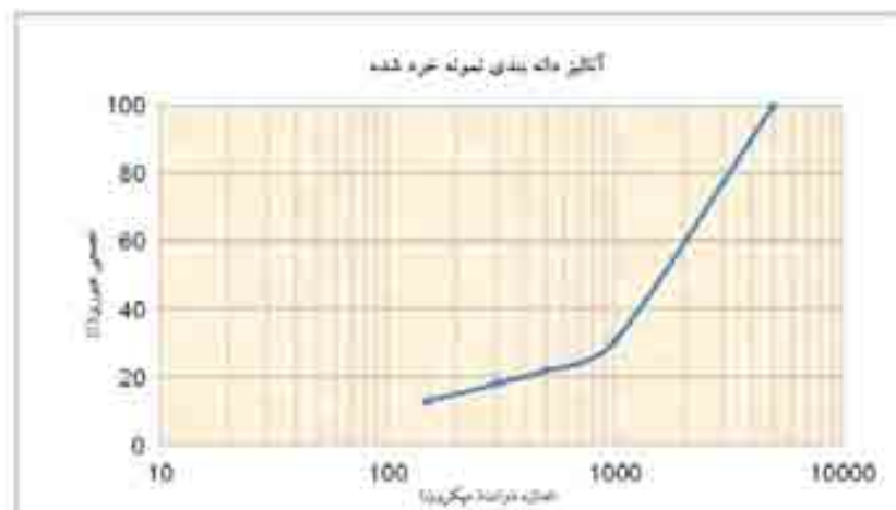
شکل ۳ نمودار آنالیز دانه بندی نمونه خرد شده.
