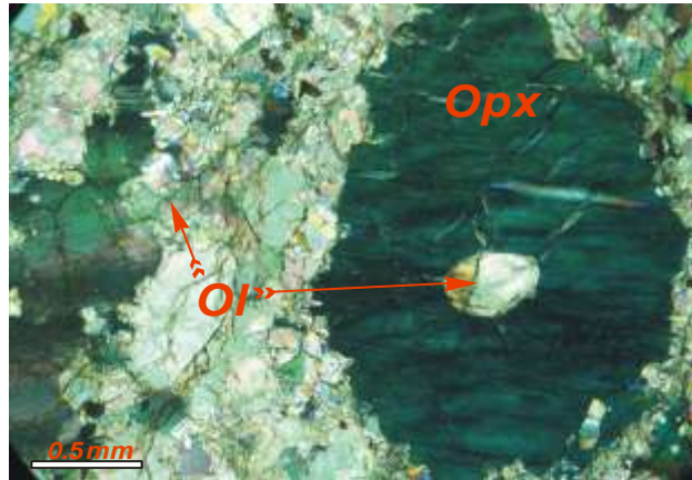
شکل ۷ بلور به تله افتاده الیوین (Ol) درون بلور ارتوپیروکسن (Opx) در سنگهای ارتوپیروکسنیتی.
