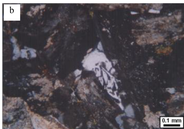
شکل ۴ (a) بافت ساب هدرال گرانولار در کوارتز سینیت، نور XPL، (b) بافت گرانوفیر در کوارتز سینیت، نور XPL.
