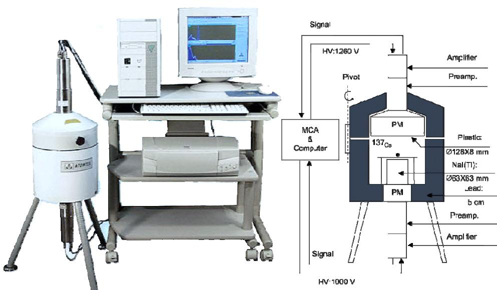
شکل ۲ نمایی از بیناب سنج  $\beta$ - $\gamma$  مدل AT1315 همراه با برش شماتیک.
