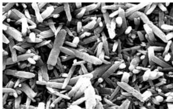
شکل ۶ تصویر میکروسکوپی SEM یک نمونه نیتريد سيليسيم حکاکی شده با NaOH در دمای 450^\circ\text{C} به مدت ۷ دقیقه.
