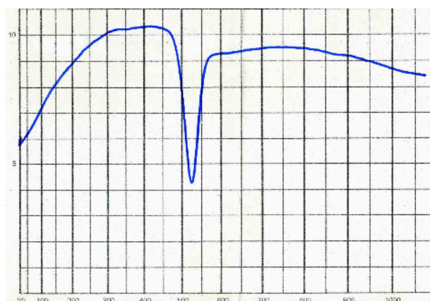
شکل ۲ منحنی آنالیز گرمایی (DTA) حاصل از خاک بوکسیت بیگلر.
