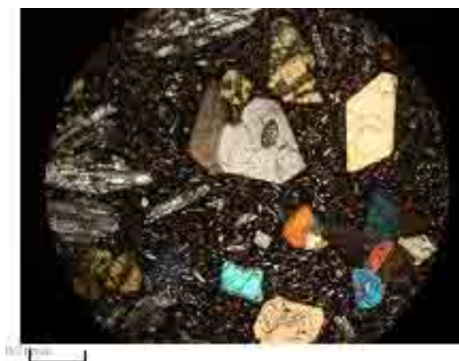
شکل ۵: نمایی از اولیوین بازالت آندزیتی (با آنالیزور).
