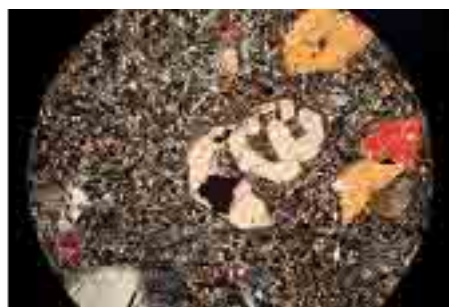
شکل ۴. نمایی از خوردگی خلیجی بلور اوژیت با حاشیه غنی از Ti (با آنالیزور).
