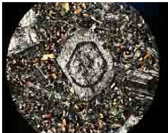
شکل ۷: نمایی از بلور دگرسان شده پلاژیوکلاز با رسی شدن منطقه‌ای در سنگ آندزیت بازالتی (سمت راست با آنالیزور - سمت چپ بدون آنالیزور).
