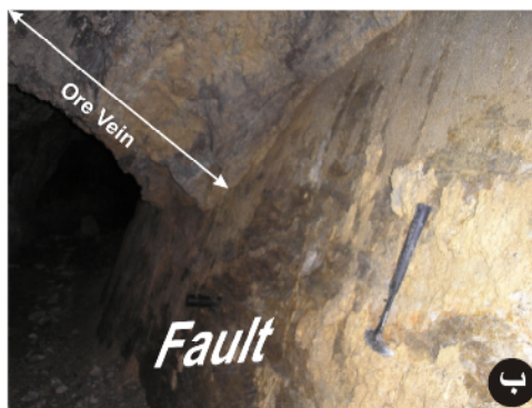
شکل ۴ الف) رگه‌ی اصلی حاوی گالن، اسفالریت و کلسیت در کانسار ارم کوچک که در راستای گسل شمال غربی-جنوب شرقی تشکیل شده است. B- رخنمونی از رگه‌ی کانه‌دار در تونل اصلی کانسار آساران که با گسل کنترل شده است.
