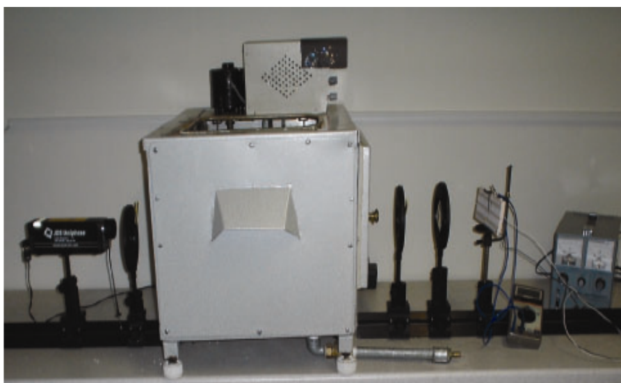
شکل ۲ مجموعه‌ی دستگاه نوری برای اندازه‌گیری آهنگ رشد بلور.
