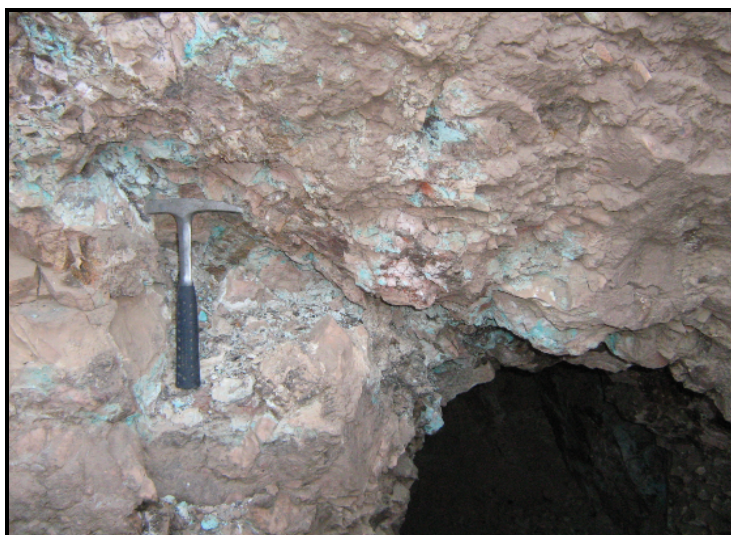
شکل ۲ حضور ملاکیت وسیع در سطح تونل‌های قدیمی.
