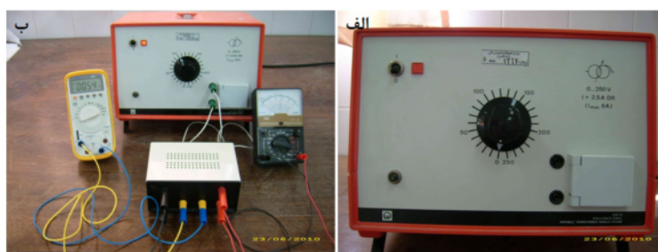
شکل ۵ الف. ترانسفورماتور کنترل کننده ولتاژ تزریقی. ب. مبذل جریان مستقیم و چگونگی ارتباط آن با ترانسفورماتور، ولت متر و آمپر متر.
