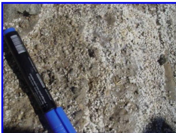
شکل ۶ اشکال مدور گرهک دار با ترکیب آلکسیت.
