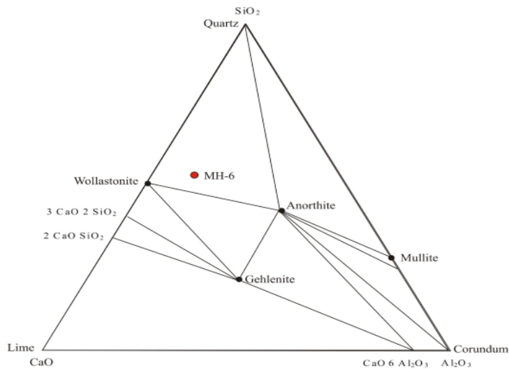
شکل ۸ سیستم ۳ تایی CaO-SiO_2-Al_2O_3 و ترکیب نمونه‌ی MH-6 [۱۴]. SiO_2 = 54.02 CaO = 35.12 Al_2O_3 = 10.8
