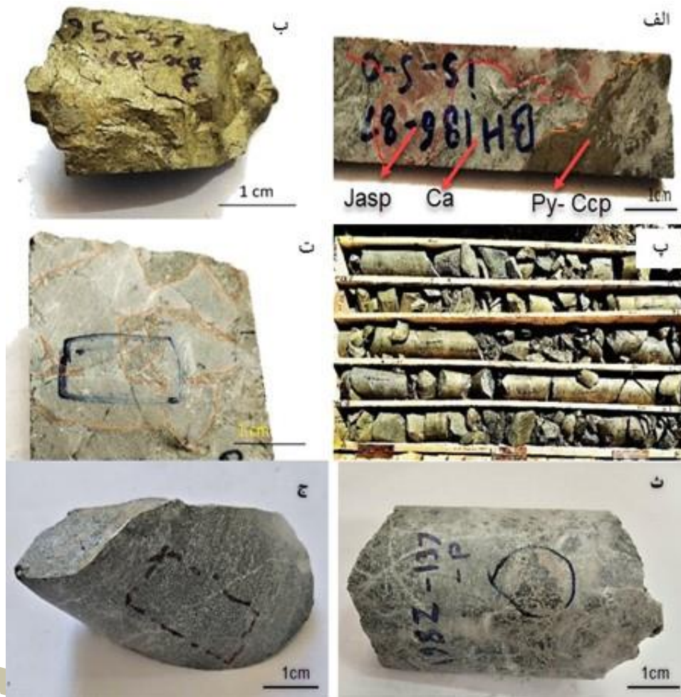
شکل ۱۲- الف- مرز بین کانه‌زایی سولفید توده‌ای با ژاسپر و کلسیت درون مغزه حفاری برش خورده که به رنگ نارنجی نشان داده شده است . [۱۸]. ب- نمونه دستی از کالکوپیریت در زون سولفید توده‌ای. پ- کانه‌زایی سولفید توده‌ای درون مغزه‌های حفاری در زیر افق ژاسپری. ت- زون استرینگر برشی درون مغزه حفاری که با رنگ نارنجی مشخص شده است. این زون نیز در زیر زون سولفید توده‌ای قرار دارد و حاوی مقادیر کمی کانی پیریت و کالکوپیریت می‌باشد. ث- زون اسرینگر با زمینه بازالت به همراه رگچه‌های پیریتی و سیلیسی و ج- بازالت تحتانی
