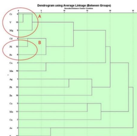
شکل ۶ نمودار تحلیل خوشه‌ای عناصر برآمده از داده‌های بهنجار در رگه‌های کانه‌دار کانسار آهن کرات
