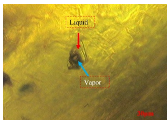
شکل ۱۰ سیال‌های درگیر در کانی گارنت نوع آندرادیت. میانبار دو فاز غنی از مایع آبگین و بخار. این میانبارها اولیه بوده و در راستای زوایای خطوط رشد گارنت دیده شده‌اند.
