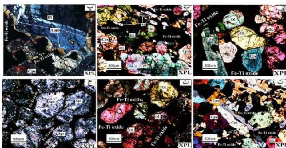
شکل ۳ تصاویر میکروسکوپی از انواع سنگ‌های فرامافیک GhMU: الف) دونیت کانه‌زایی شده، ب) ورلیت آپاتیت‌دار کانه‌زایی شده، پ) نمونه مافیک کانه‌زایی شده همراه با لبه واکنشی از هورنبلند، ت) نمونه ورلیت آپاتیت‌دار کانی‌زایی شده، ث) نمونه دونیت کانه‌زایی شده، ج) نمونه سرپانتینیت کانی‌زایی شده. Plg: پلاژیوکلاز، Hor: هورنبلند، Spl: اسپینل، Ol: الیوین، Opx: ارتوپروکسن، Cpx: پروکسن [۱۶].
