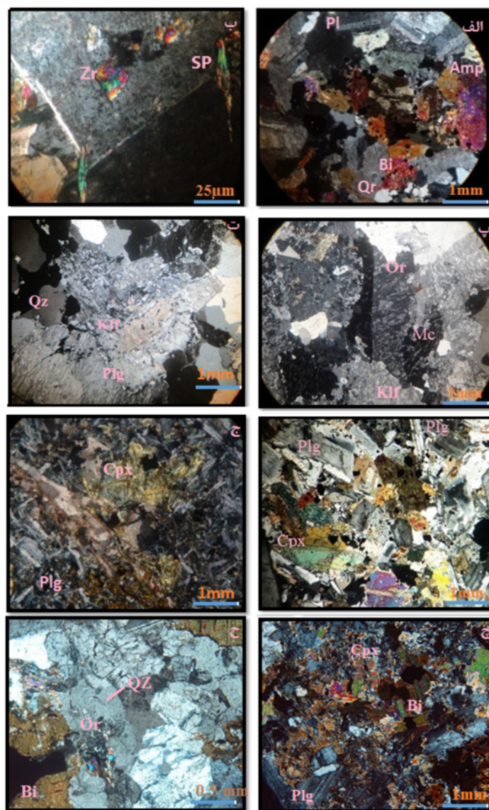
شکل ۳ تصاویر میکروسکوپی توده‌های نفوذی منطقه: الف-گرانودیوریت شامل بلورهای پلاژیوکلاز، فلدسپار قلیایی، کوارتز، بیوتیت و به مقدار کم آمفیبول با بافت دانه‌ای و خال‌خال (پیرامون روستای دیزج)، ب- تشکیل زیرکن و اسفن در فلدسپار قلیایی در متن گرانودیوریت، پ- بافت گرافیکی و هم‌رشدی پرتیتی در گرانیت قلیایی، ت- بافت راپاکیو و پرتیتی در گرانیت قلیایی، ث- بافت‌های دانه‌ای، پوست‌ماری و نیمه‌پوست‌ماری و پیروکسن با منطقه بندی دوقلویی در گابرو دیوریت جنوب تیکمه داش، ج- بافت نیمه‌پوست‌ماری و میان‌دانه‌ای، تبدیل پیروکسن به آمفیبول و کلریت، تبدیل برخی پلاژیوکلازها به اپیدوت از محل شکستگی‌ها، قطع شدن سنگ توسط رگچه ثانویه کلسیت در دایک دیابازی، چ- بافت ریزدانه‌ای و نهان‌دانه‌ای پورفیری در درون‌بوم مونزودیوریتی و ح- بافت گرافیکی در درون‌بوم مونزونیته.
