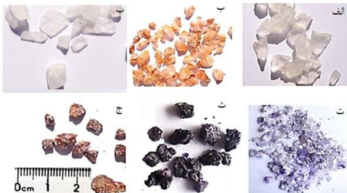
شکل ۲ انواع فلوئوریت‌های رنگی و بی‌رنگ مورد بررسی: الف- نمونه بی‌رنگ، ب- نمونه قهوه‌ای کم‌رنگ (کرم رنگ)، پ- نمونه سفیدرنگ (نباتی)، ت- نمونه بنفش کم‌رنگ، ث- نمونه بنفش تیره و ج- نمونه قهوه‌ای پررنگ.
