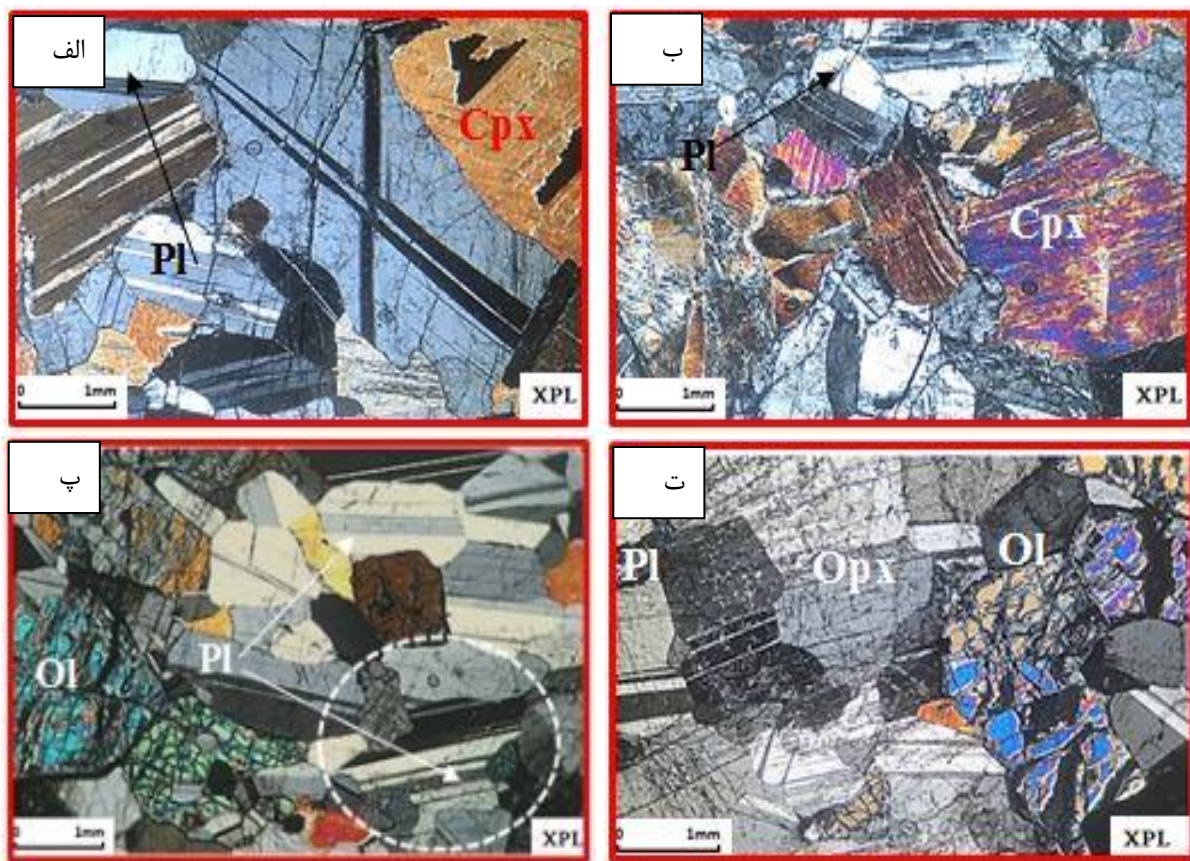
شکل ۹ تصاویری میکروسکوپی از گابروهای، مجموعه افیولیتی دشت سمسور: الف ( پلاژیوکلاز (Pl) دانه درشت با ماکل چندریخت و کارلسباد، کلینوپیروکسن (Cpx)، ب) وجود پلاژیوکلاز (Pl) و کلینوپیروکسن (Cpx) که هر دو در حال دگرسان شدن هستند، پ) بلورهای سالم و دانه درشت پلاژیوکلاز (Pl) با ماکل چندریخت، کارلسباد و کانی دانه درشت اولیوین (Ol) در اولیوین گابرو، ت) کانی پلاژیوکلاز (Pl) به نسبت سالم، دارای ماکل چندریخت و کانی‌های اولیوین (Ol) و ارتوپیروکسن (Opx) در ترکتولیت‌ها (همه تصاویر در نور قطبیده متقاطع (XPL) با بزرگ‌نمایی 40X تهیه شده‌اند).
