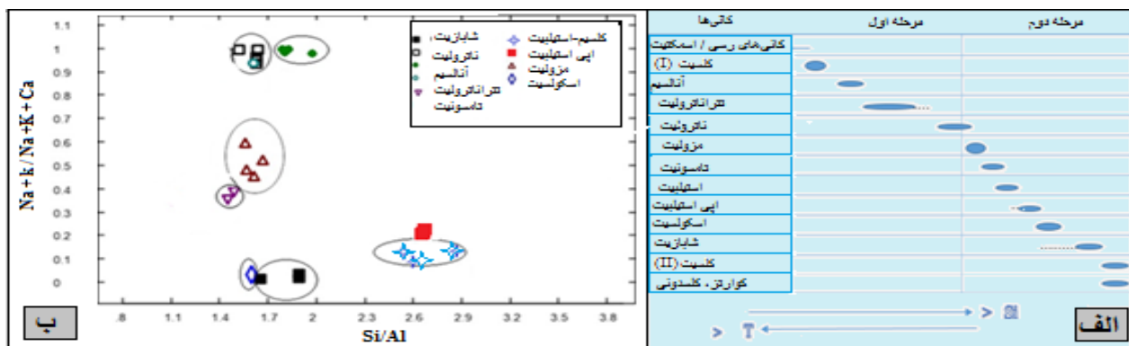
شکل ۶ الف- نمودار \text{Si/Al} نسبت به \text{Na+K/(Na+K+Ca)} برای تعیین ترکیب زئولیت‌ها در منطقه پرندک که تغییرات گسترده‌ای را در نسبت \text{Na+K/(Na+K+Ca)} نشان می‌دهد و ب- توالی تبلور زئولیت‌ها در حفره‌ها و شکستگی‌های سنگ‌های بازی منطقه پرندک.
