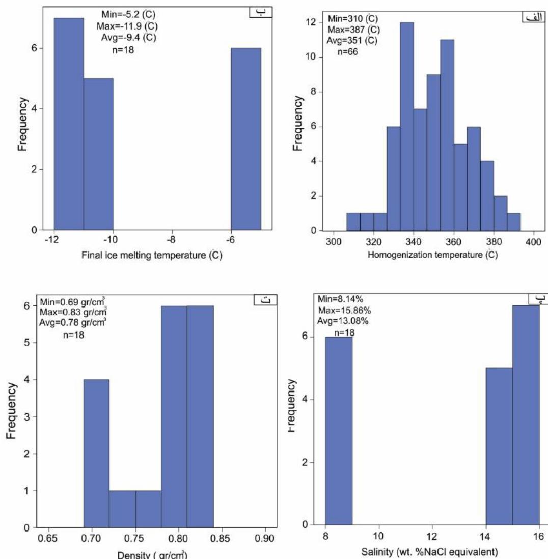
شکل ۷ نمودارهای ستونی مربوط به تجزیه سیال‌های درگیر منطقه زاویه. (الف) نمودار ستونی دمای همگن شدن. (ب) نمودار ستونی آخرین دمای ذوب یخ. (پ) نمودار ستونی مقدار شوری. (ت) نمودار ستونی مقدار چگالی.
