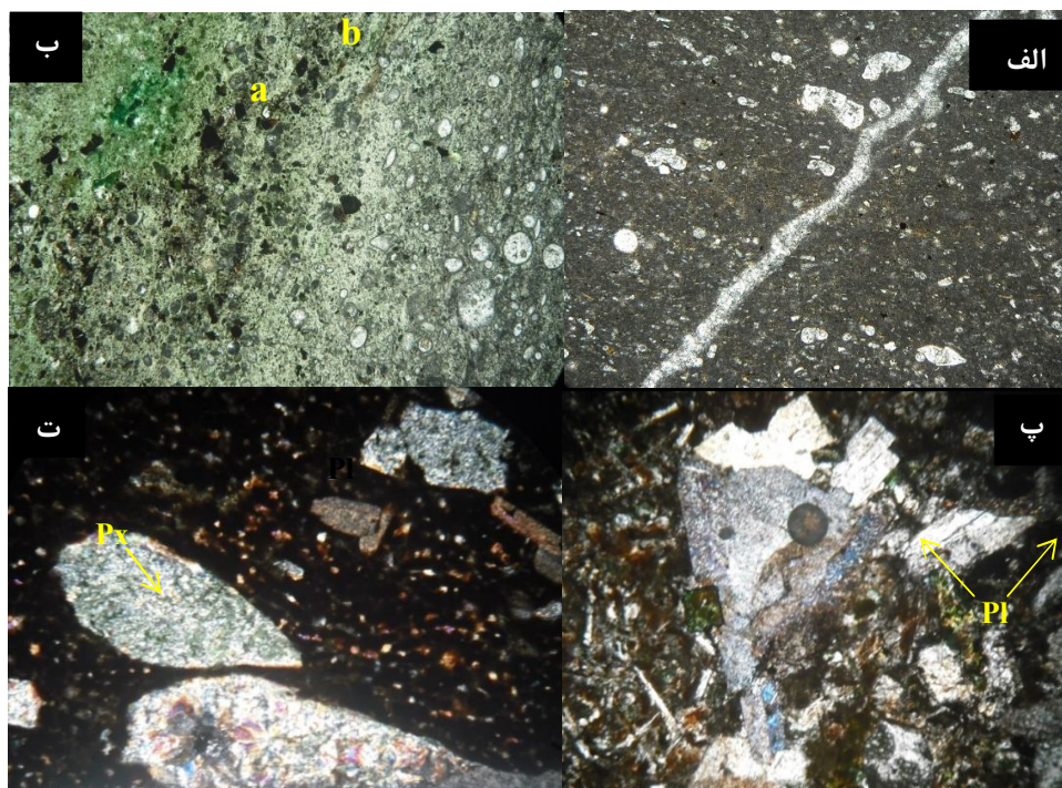
شکل ۲ - الف- تصویر میکروسکوپی کانی‌سازی هماتیت و مگنتیت در داخل سنگ آهک، ب- تصویر میکروسکوپی سنگواره‌های گلوبوترونکانا (a) و گانسرینا گانسری (b) در داخل سنگ آهک، پ - تصویر میکروسکوپی آندزیت- بازالت با بافت بادامکی که حفرات توسط سیلیس پر شده- اند، ت- تصویر میکروسکوپی بافت گلومروپورفیری در پیروکسن هورنبلند آندزیت که پیروکسن به کلریت تبدیل شده است و هورنبلندها به اکسیدهای آهن تجزیه شده‌اند.
