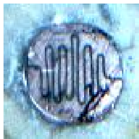
شکل ۴ تصویر نمونه ۴ با الکترودهای طلا، آماده شده برای اندازه‌گیریهای اپتیکی. فاصله الکترودها از یکدیگر 1 mm است.
