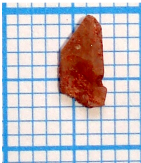
شکل ۶ بس بلور \text{ZnS}_{0.5}\text{Se}_{0.5} رشد یافته در دمای 982^\circ\text{C} .
