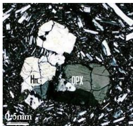
شکل ۴ اجتماع ارتوپیروکسن و هورنبلند و تشکیل بافت گلومروپرفیری در آندزیت (XPL).
