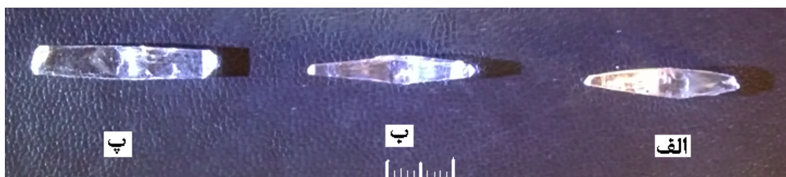
شکل ۳ بلورهای رشد داده شده از محلول KDP با الف: \text{Al}(\text{NO}_3)_3 ۰/۰۰۱ wt% ، ب: \text{Fe}(\text{NO}_3)_3 ۰/۰۰۱ wt% ، پ: \text{Cu}(\text{NO}_3)_2 ۰/۰۰۱ wt%.
