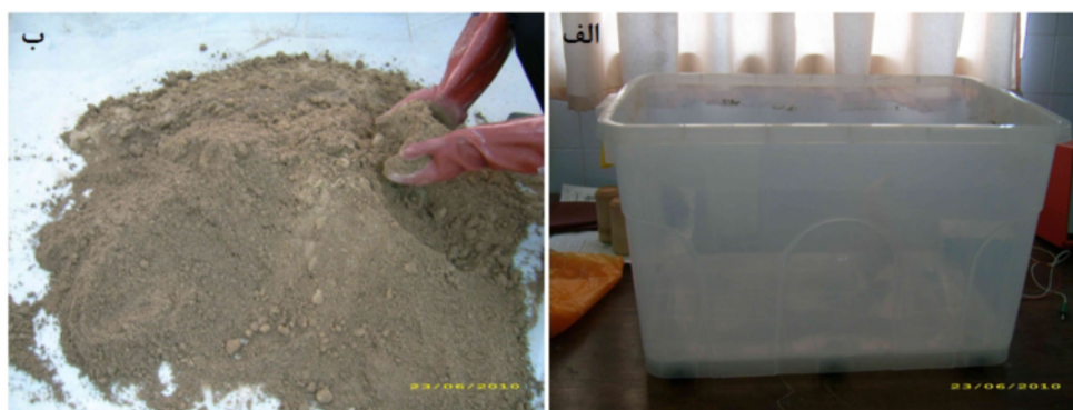
شکل ۴ الف. تانک پلاستیکی مورد استفاده در مدل آزمایشگاهی ب. آماده‌سازی خاک با تهیه‌ی مخلوط با نسبت مشخص از ماسه و رس.
