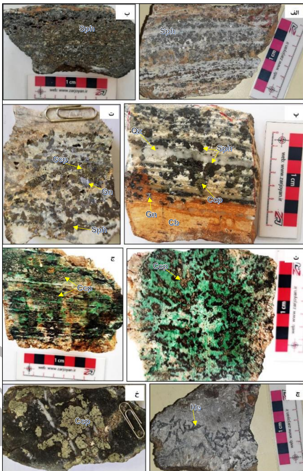
شکل ۸) تصاویر نمونه دستی از کانه‌زایی مس (سرب- روی) در کانسار قوزلو. الف) بافت شبه لامینه کانه‌زایی اسفالریت و گالن در سنگ میزبان کربناتی سیلیسی شده؛ ب) کانه‌زایی اسفالریت و گالن با بافت توده‌ای؛ پ) بافت شبه لامینه کانه‌زایی اسفالریت و گالن در سنگ میزبان کربناتی سیلیسی شده؛ ت) اسفالریت، گالن و کالکوپیریت با بافت دانه پراکنده در زمینه کربناتی؛ ث) تشکیل اسفالریت با بافت دانه پراکنده در زمینه سیلیسی؛ ج) تشکیل کالکوپیریت با بافت لامینه‌ای تا شبه لامینه‌ای؛ چ) تشکیل هماتیت با بافت رگچه‌ای و پراکنده در زمینه؛ خ) تشکیل کالکوپیریت با بافت دانه پراکنده در بخش آمفیبولیت متاسوماتیزه، (Gn: گالن، Ccp: کالکوپیریت، Cb: کربنات، Qz: کوارتز، Sp: اسفالریت).
