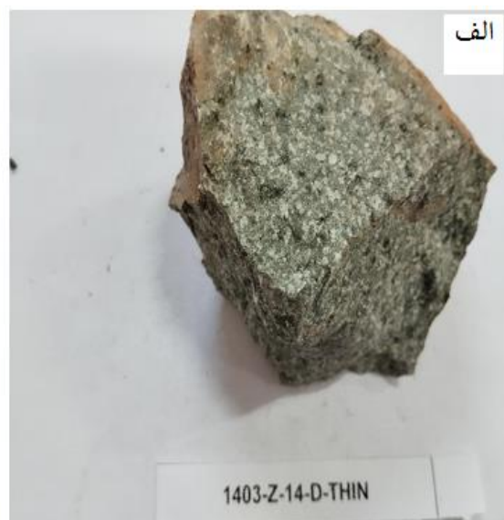
شکل ۴- الف- واحد آندزیتی در نمونه دستی و ب- همان نمونه در مقطع میکروسکوپی XPL که دگرسانی سرسیتی و کلریتی در آن مشاهده می‌گردد. Chl: کلریت، Ser: سرسیت، Mc: میکروکلین [۱۸].
