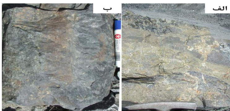
شکل ۹ الف) پیریت رگه‌ای که مگنتیت را قطع کرده و نشاندهنده روزادی بودن آن است، ب) پیریت به صورت انتشاری روی مگنتیت قرار دارد و بخشی از مگنتیت که به هماتیت تبدیل شده است.
