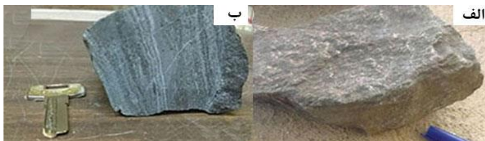
شکل ۸ الف) مگنتیت با بافت توده‌ای همراه با کوارتز و باریت، ب) مگنتیت با بافت نواری همراه با کوارتز و باریت.
