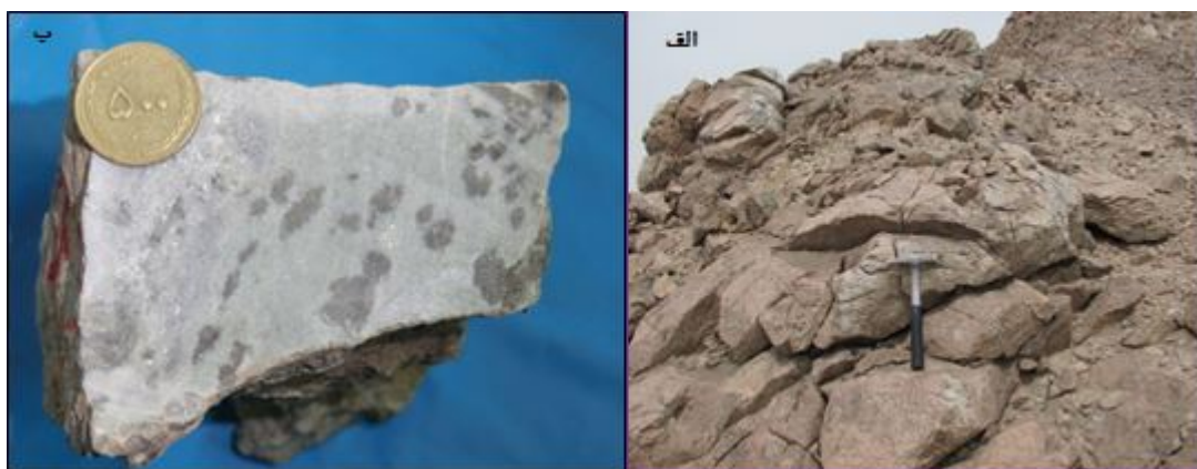
شکل ۶ الف) برونزد اسکارن‌های سیاه کمر، ب) نمونه دستی برش خورده از اسکارن‌های سیاه کمر با لکه‌های گارنت در سطح نمونه.
