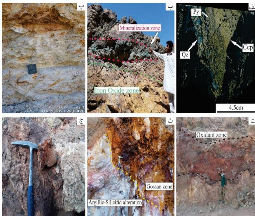
شکل ۴ کانی‌سازی در منطقه اکتشافی زردکوه، الف) تصویر نمونه دستی از حضور کانی‌های کالکوپیریت و پیریت به صورت پراکنده و رگچه‌ای در رگچه‌های رگچه‌های سیلیسی (Ccp: کالکوپیریت، Py: پیریت، Qz: کوارتز)، ب) کانی‌زایی مالاکیت، آزوریت به همراه اکسیدهای آهن، پ) رگچه‌های داربستی پیریت که در اثر اکسایش تبدیل به ژاورسیت و لیمونیت شده‌اند، ت) پهنه اکسایشی تشکیل شده در سطح زمین، ث) پهنه گوسان در کنار دگرسانی‌های آرژلیک و سیلیسی، ج) حضور سیلیس‌های خاکستری که اغلب شامل هماتیت و گوتیت هستند. [۱۵].
