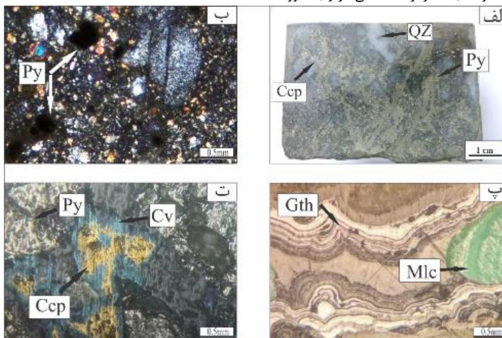
شکل ۶ تصاویری از بافت‌های کانی‌زایی در منطقه اکتشافی زردکوه: الف) بافت رگچه‌ای کانی‌های کالکوپیریت و پیریت درون زمینه سیلیس، ب) بافت پراکنده، پ) بافت گل کلمی در مالاکیت و گوتیت، ت) بافت جانشینی ثانویه کولیت در لبه کالکوپیریت و پیریت، [۱۵] Ccp: کالکوپیریت، Py: پیریت، Qz: کوارتز، Cv: کولیت، Mlc: مالاکیت و Gth: گوتیت. تصاویر میکروسکوپی در نور XPL گرفته شده‌اند.
