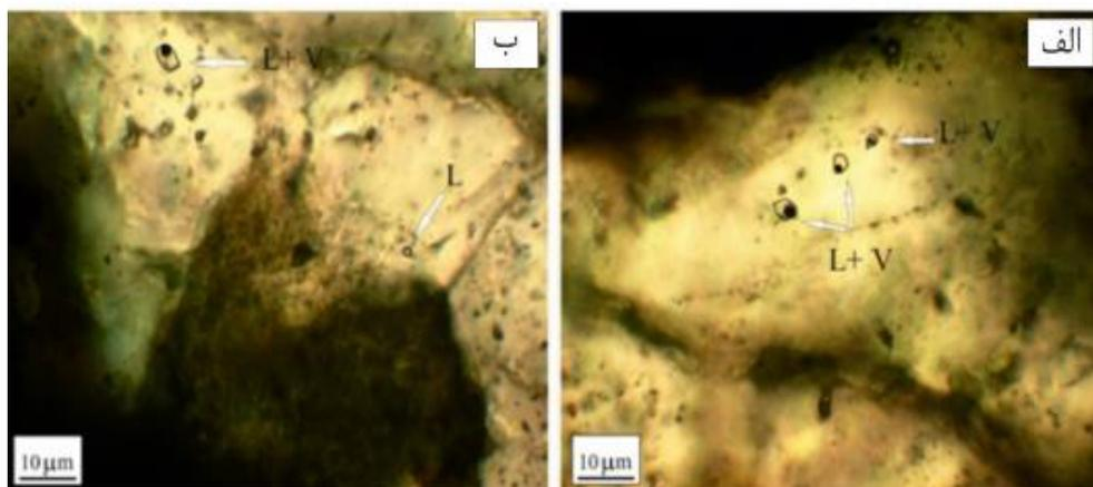
شکل ۷ تصاویری از سیال‌های درگیر در رگچه‌های کوارتز و کوارتز + پیریت + کالکوپریت در منطقه اکتشافی زردکوه، الف) سیال‌های دو فازی غنی از مایع (LV)، ب) سیال‌های دو فازی غنی از مایع (LV) و تک فازی مایع (L).
