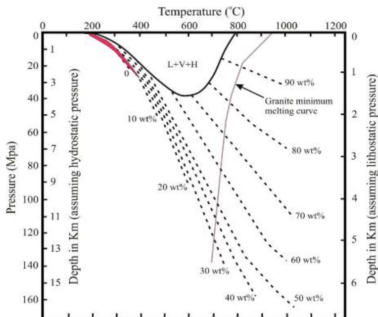
شکل ۱۰ نمودار فشار-دما نشان‌دهنده رابطه فازها در سامانه  $H_2O-NaCl$  در فشارهای ایستایی و سنگ ایستایی که منطقه زردکوه در آن مشخص شده است [۱۴]. (L = مایع، V = بخار، H = حالت). خط‌چین‌ها پربندهای ثابت درصد وزنی NaCl محلول در شوره هستند. خط باریک خاکستری منحنی کمترین ذوب گرانیب و خط ضخیم مشکی مرز سه‌فازی، L+V+H را برای سامانه  $NaCl-KCl-H_2O$  با Na/K در محلول ثابت شده بوسیله آل‌بیت و فلدسپار قلیایی در دماهای مشخص نشان می‌دهد.
