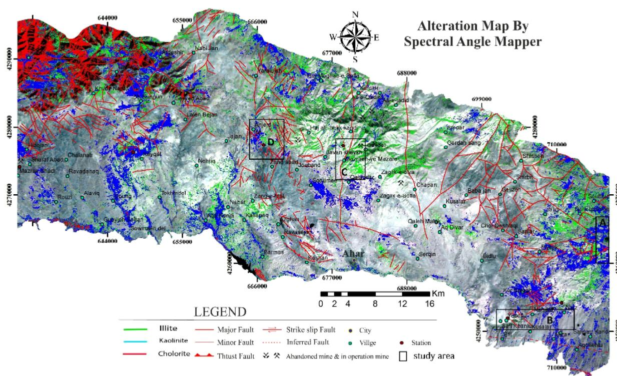
شکل ۱۱ نقشه دگرسانی‌های منطقه اهر-رسباران تهیه شده به روش نقشه برداری زاویه طیفی (SAM)، محدوده کانسارهای انتخاب شده با کادر سفید روی نقشه نشان داده شده است (A: کوچنق، B: نیاز و صفائی خانلو، C: مزرعه، D: انجرد).
