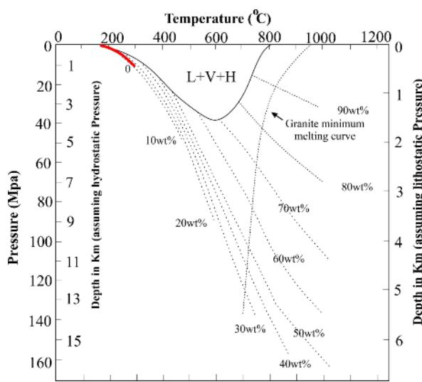
شکل ۱۰ نمودار فشار- دمای نشان‌دهنده رابطه فازها در سامانه  $\text{H}_2\text{O}-\text{NaCl}$  در فشارهای هیدروایستایی و سنگ ایستایی [۲۵]، L = مایع، V = بخار، H = هالیت. خط‌چین‌ها پریندهای ثابت درصد وزنی  $\text{NaCl}$  محلول در شورابه هستند. خط باریک خاکستری منحنی کمترین ذوب گرانیت را مشخص می‌کند. خط ضخیم مشکی موز سه فازی، H را برای سامانه  $\text{NaCl}-\text{KCl}-\text{H}_2\text{O}$  با  $\text{Na}/\text{K}$  در محلول ثابت شده بوسیله آلبیت و فلدسپار قلیابی در دماهای مشخص نشان می‌دهد.
