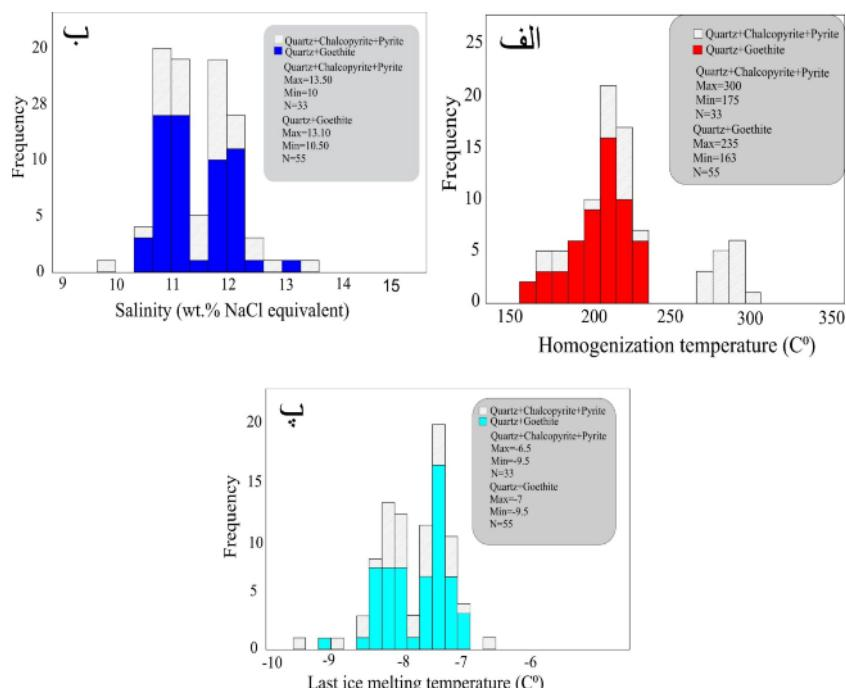
شکل ۷ نمودارهای ستونی برای کانی‌سازی رگه‌ای در منطقه سیاجک: الف) دماهی همگن‌شدگی، ب) شوری، پ) آخرین دماهی ذوب بخ.
