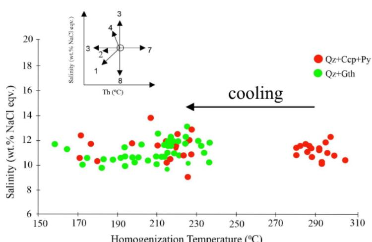
شکل ۸ نمودار شوری نسبت به دماهی همگن‌شدگی سیال‌های درگیر منطقه سیاجک و روندهای ممکن تکامل سیال در نمودار دما-شوری از مرجع [۲۳]، روند ۱: مخلوط شدگی سیال A با سیال سرددتر و با شوری کمتر B، روندهای ۲ و ۳: مخلوط شدگی سیال A با میانبارهای سیال با شورهای مختلف ولی دمای یکسان، روند ۴: شوری فاز باقیمانده در اثر جوشش افزایش یافته است، روند ۵: سرددشگی سیال، روند ۶: باریک شدگی میانبارهای سیال، روند ۷: تراوش میانبارهای سیال طی گرمایش.
