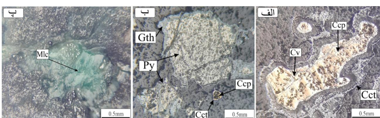
شکل ۳ تصاویر میکروسکوپی از کانه‌های منطقه اکتشافی سیاجک: (الف) دانه‌های پراکنده کالکوپیریت و پیریت درون کوارتز که در لبه بافت جانشینی ثانویه کالکوسیت در نتیجه اکسید شدن کالکوپیریت و پیریت دیده می‌شود، (ب) جانشینی گوتیت و کالکوسیت درنتیجه اکسید شدن کالکوپیریت و پیریت، (پ) دانه‌های مالاکیت در پی جانشینی کالکوپیریت (Ccp: کالکوپیریت، Gth: گوتیت، Cv: گوتیت، Cct: گوتیت، Mlc: مالاکیت، Py: پیریت، [۱۹]).
