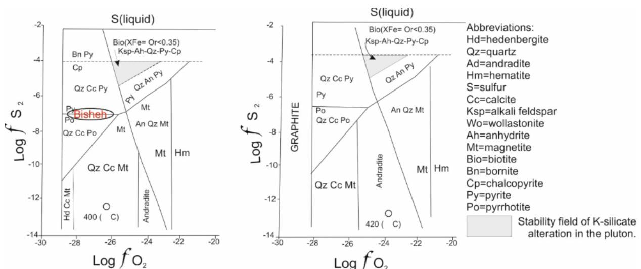
شکل ۱۵ نمودار گریزندگی  $\log f\text{O}_2$  نسبت به  $\log f\text{S}_2$  برای تعیین گستره پایداری آندرادیت در دمای ۴۰۰ و ۴۲۰ درجه سانتیگراد و  $\text{XCO}_2 = 0.1$ . [۳۶]
