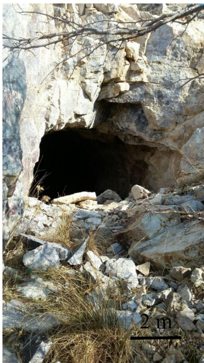
شکل ۴ بخش کوارتز-آلونیتی در دهانه تونل A که براساس طیف پراش پرتو ایکس، نمونه برداشت شده از این قسمت دارای ۵۶٫۷ درصد آلونیت و ۴۳٫۷ درصد کوارتز است.
