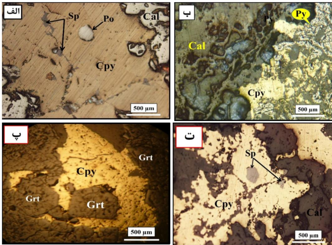
شکل ۴ تصاویر میکروسکوپی از کاننگاری در اسکارن‌ها و مرم‌های سولفیدی خود در نور بازتابی: الف- کان‌زایی پیروتیت و اسفالریت به ترتیب به صورت میانبار و رگج‌های (شکافه پرکن) در مرم‌های سولفیدی، ب) رخداد پیریت و کالکوپیریت به صورت جان‌شینی در مرم‌های سولفیدی، پ) رخداد کالکوپیریت به صورت پرکننده فضای خالی بین بلورهای گارنت در گارنت اسکارن و ت) کان‌زایی اسفالریت به صورت میانبار در مرم‌های سولفیدی.
