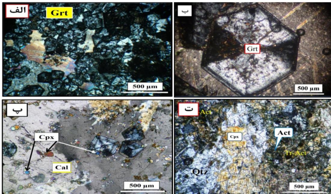
شکل ۲ تصاویر میکروسکوپی از پهنه گارنت-پيروكسن اسكارن در كانسار خود: الف) گارنت‌های درشت‌بلور كه بیش از ۵۰ درصد سنگ اسكارنی را تشكيل داده است، ب) منطقه‌بندی نوسانی و ماكل قطاعی در گارنت‌های ناهمسانگرد، پ) كلینوپيروكسن به صورت میانبار در گارنت‌ها و ت) جانیشینی كلینوپيروكسن با فرواكتینولیت. همه تصاویر در نور قطبیده متقاطع (XPL) تهیه شده‌اند.
