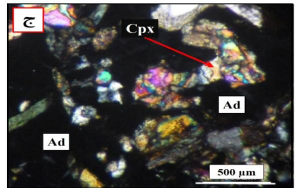
شکل ۳ تصاویر میکروسکوپی از پهنه گارنت اسکارن در کانسار خود در نور قطبیده ساده و متقاطع: الف و ب) بافت دانه‌ای و ماکل قطاعی در گارنت‌های ناهمسانگرد خودشکل (نوع I) به ترتیب در نور قطبیده متقاطع و ساده، پ) گارنت‌های همسانگرد خودشکل با بافت دانه‌ای (نوع II)، ت) ناهمسانگردی ضعیف در لبه گارنت‌های همسانگرد خودشکل (نوع II)، ث) جانیشینی گارنت با اپیدوت و کلریت در مرکز گارنت‌ها (نوع II) و ج) گارنت‌های همسانگرد بی‌شکل و بدون منطقه بندی (نوع III).
