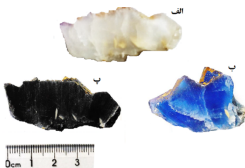
شکل ۵ الف- نمونه بی‌رنگ پیش از پرتو دهی. ب-قطعه‌ای از همان نمونه پس از پرتو دهی با پرتوگاما با شدت ۲٫۵ کیلوگرمی که به رنگ آبی آسمانی درآمده است و پ-همان نمونه پس از پرتو دهی گاما با شدت ۸۸ کیلوگرمی که به رنگ خاکستری تیره درآمده است.
