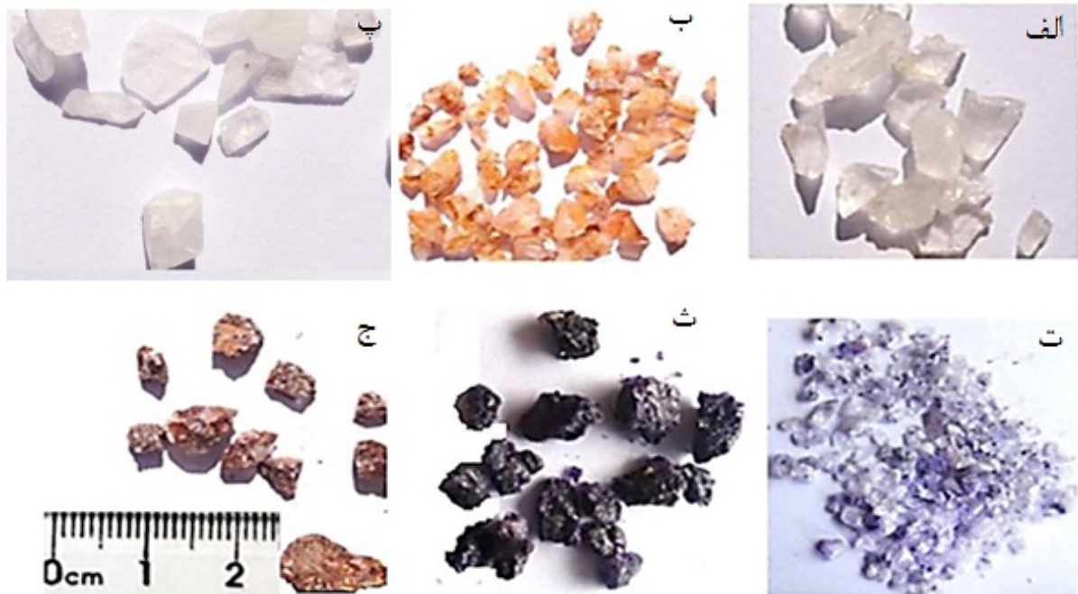
شکل ۲ انواع فلئوریت‌های رنگی و بی‌رنگ مورد بررسی: الف- نمونه بی‌رنگ، ب- نمونه قهوه‌ای کم‌رنگ (کرم رنگ)، پ- نمونه سفیدرنگ (نباتی)، ت- نمونه بنفش کم‌رنگ، ث- نمونه بنفش تیره و ج- نمونه قهوه‌ای پررنگ.
