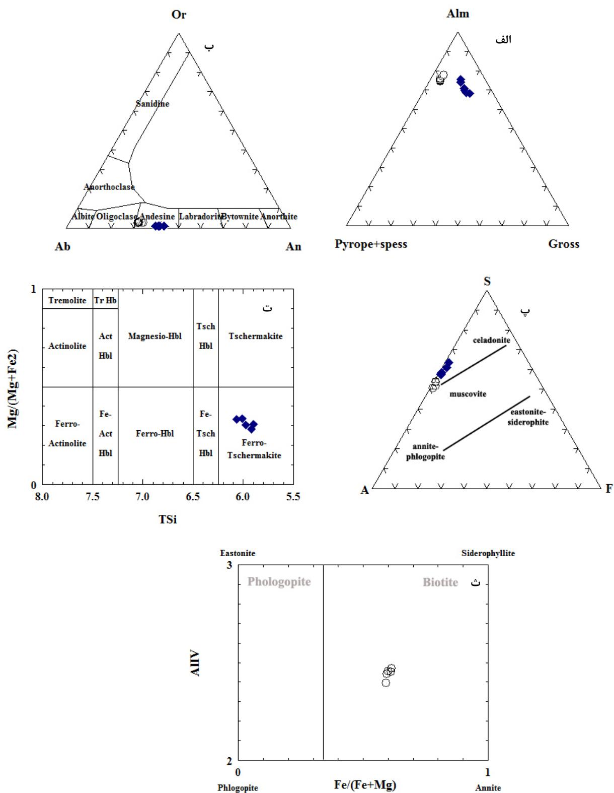
شکل ۷ (الف) جایگاه بلورهای گارنت در نمودار آلماندن-گروسوولار-پیروپ + اسپسارت [۱۲]، (ب) جایگاه کانی‌های پلازیوکلاز در نمودار آنورتیت-آلبیت-اورتوز [۱۳]، (پ) جایگاه ترکیب شیمیایی بلورهای میکائی سفید در نمودار سه تایی  $\text{SiO}_2\text{-Al}_2\text{O}_3\text{-FeO}$  [۱۴]، (ت) جایگاه بلورهای آمفیبول در نمودار مرجع [۱۵] و (ث) ترکیب شیمیایی بلورهای بیوتیت در نمودار مرجع [۱۲].
