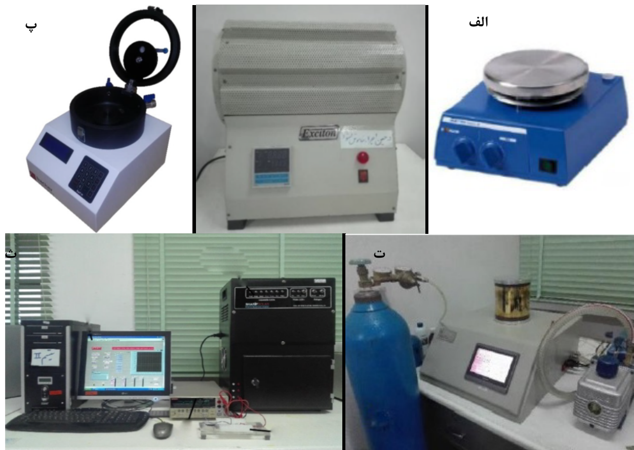
شکل ۲ وسایل مورد استفاده الف- دستگاه لایه‌نشانی چرخشی ب- کوره افقی پ- گرم کننده ت- دستگاه شبیه‌ساز نور خورشید و مشخصه‌یابی جریان-ولتاژ ث- دستگاه کند و پاش.
