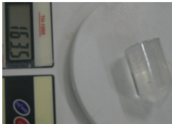
شکل ۴ بلور CsI رشد داده شده به روش بریجمن.
