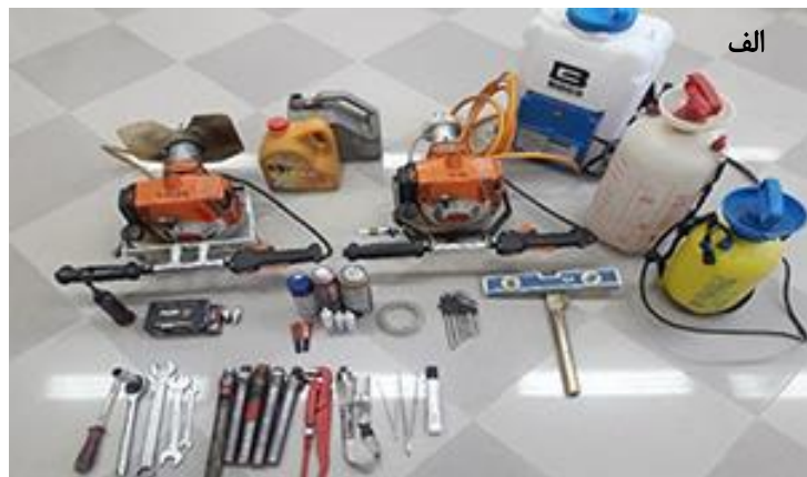
شکل ۶ الف) مجموعه وسایل مورد نیاز برای نمونه برداری (به روش مغزه‌گیری)، و ب) تصویری از چند عدد مغزه گرفته‌شده از گرانیت‌های به شدت دگرشکل شده چاه‌زرد (سمت چپ).
