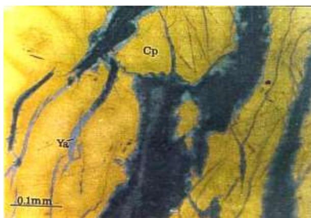
شکل ۳ تصویر نور پلازیزه از مقطع صیقلی. گسترش کانی یاروویت (Ya) بصورت رگچه‌هایی درون کالکوپیریت (Cp).
