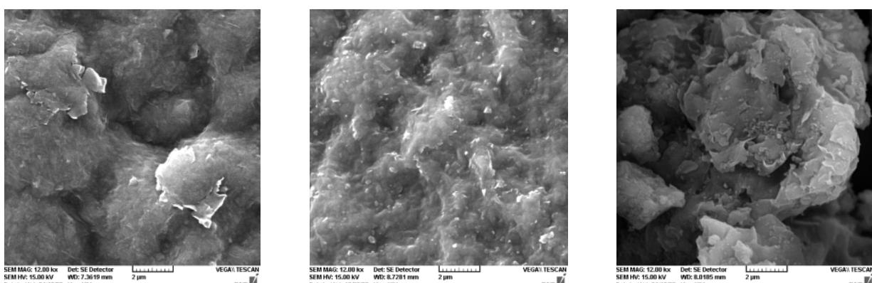
شکل ۶ تصویر میکروسکوپ الکترونی پویشی نمونه‌ی رسی بنتونیت با بزرگنمایی ۱۲۰۰۰ نمونه رسی (SLB) با بزرگنمایی ۱۲۰۰۰ برابر ۱۲۰۰۰ برابر
