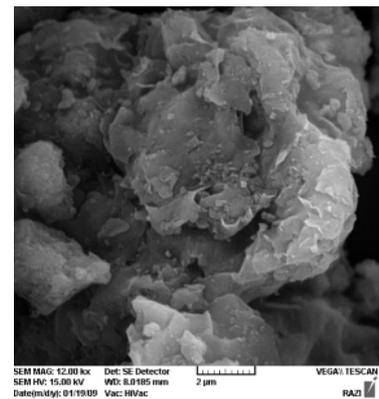
شکل ۶ تصویر میکروسکوپ الکترونی پویشی نمونه‌ی رسی بنتونیت با بزرگنمایی ۱۲۰۰۰ برابر
