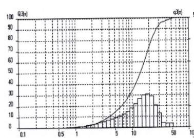
شکل (۵-ب). تعیین گستره‌ی قطر ذرات نمونه نانورس صنعتی کلوزایت  $\text{Na}^+$
