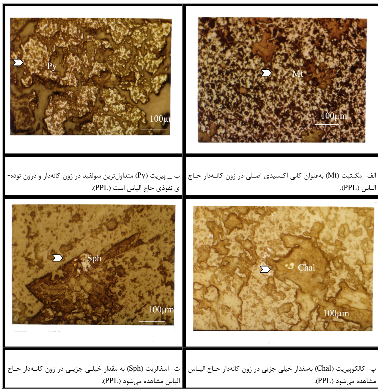
شکل ۶ مگنتیت به‌عنوان متداول‌ترین اکسید، و پیریت، کالکوپیریت و اسفالریت سولفیدهای موجود در مقاطع صیقلی به زون کانه‌دار منطقه‌ی مورد بررسی هستند.
